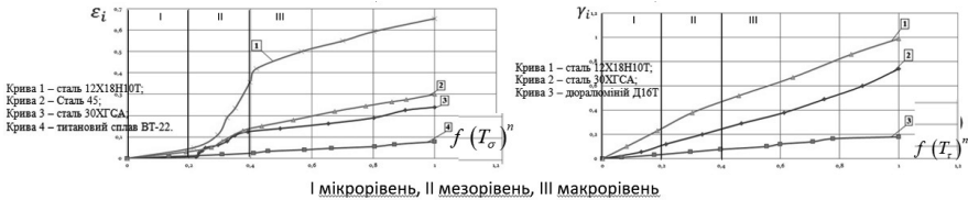
Рис. 5. Криві залежності функцій довговічності конструкційних матеріалів від величини залишкових деформацій до руйнування
