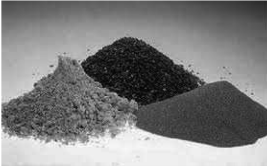
Рис.3. Порошкоподібний, дрібнозернистий та крупнозернистий абразив для вікінчувальних методів обробки деталей при вільному абразивному обробленні
