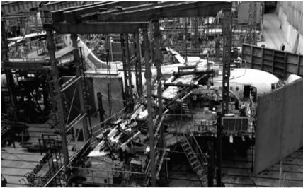
Рис. 8. Натурные (статические) усталостные испытания авиационных конструкций
