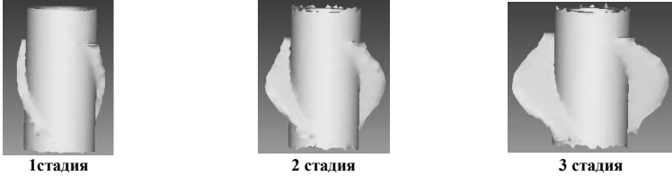
Рис. 1. - Течение металла на стадиях получения оперения при различном ходе пуансона
