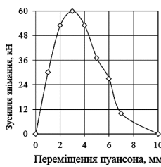
Рис. 4 – Силкові режими витягування: а – залежність зусилля витягування від переміщення пуансона, б – залежність зусилля знімання від переміщення пуансона
