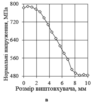
Рис. 4 - Розподіли нормальних напружень \sigma_n на деформуючому інструменті: а - на пуансоні, б - на матриці, в - на виштовхувачі
