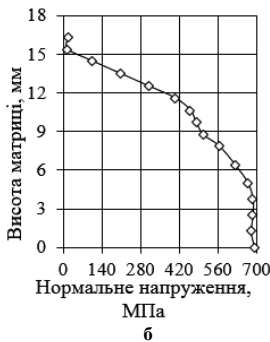
Рис. 4 - Розподіли нормальних напружень \sigma_n на деформуючому інструменті: а - на пуансоні, б - на матриці, в - на виштовхувачі
