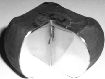
Рис. 5. Осова пористість після осадження чотирипроменевої заготовки
