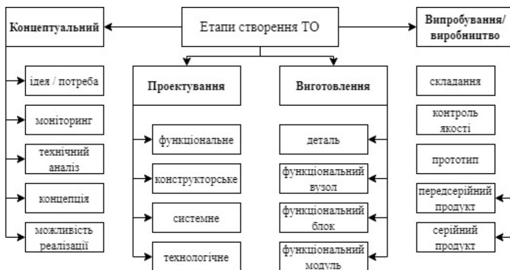
Рис.1. Етапи створення робота-маніпулятора
