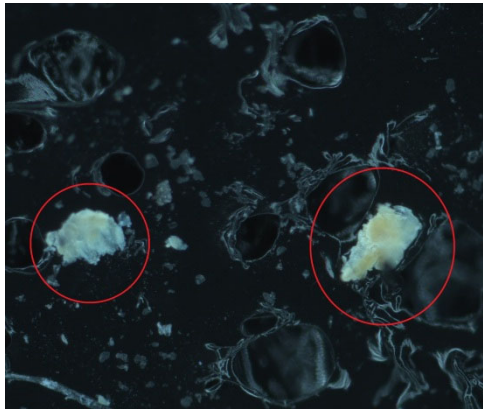
Рис. 4. Мікроскопічні часточки продуктів стирання полімеру РЕЕК
