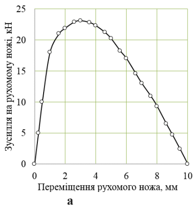
Рис. 4 – Залежності зусиль, яке витримує рухомий ніж, при відрізанні: а – залежність осевого зусилля на рухомому ножі від його переміщення, б – залежність поперечного зусилля на рухомому ножі від його переміщення
