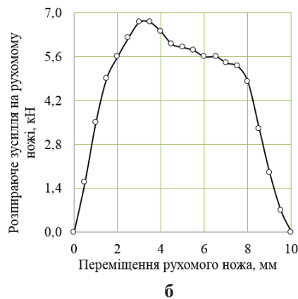
Рис. 4 – Залежності зусиль, яке витримує рухомий ніж, при відрізанні: а – залежність осевого зусилля на рухомому ножі від його переміщення, б – залежність поперечного зусилля на рухомому ножі від його переміщення
