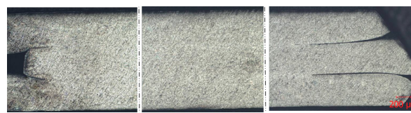
Рис. 6 - Макроструктура зразка зі сплаву ОТ4-0 при T = 840^{\circ}\text{C}
