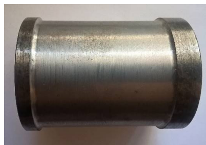
Рис. 1 - Заготовки для ротаційного видавлювання: а - ескіз заготовки, б – вихідна заготовка, яка отримана точінням з прокату
