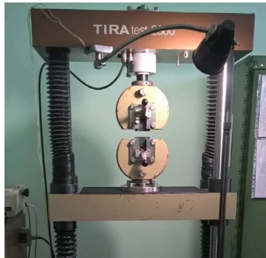
Рис. 4 - Зразки для проведення експериментів на одновісний розтяг, які встановлені на машині TIRA test 2300
