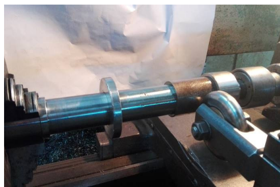
Рис. 2 - Схема ротаційного видавлювання та експериментальне оснащення на універсальному токарному обладнанні показані: а – схема ротаційного видавлювання, б - експериментальне уснащення на універсальному токарному обладнанні
