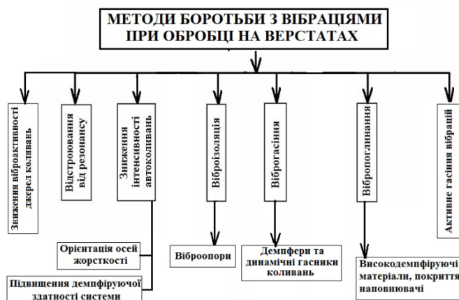
Рис. 1. Основні методи боротьби з недопустимими вібраціями при обробці на верстатах [1]
