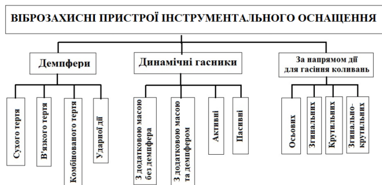
Рис. 2. Способи гасіння вібрацій при різанні на верстаті
