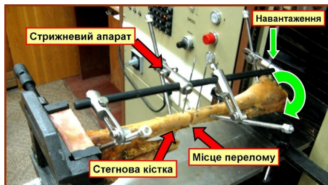
Рис. 1 - Схема навантаження зразків при виконанні лабораторної роботи «Вивчення деформування систем остеосинтезу при згині»
