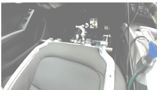
Рис. 2. Механізм з важелем, який впливає на педаль подачі палива
