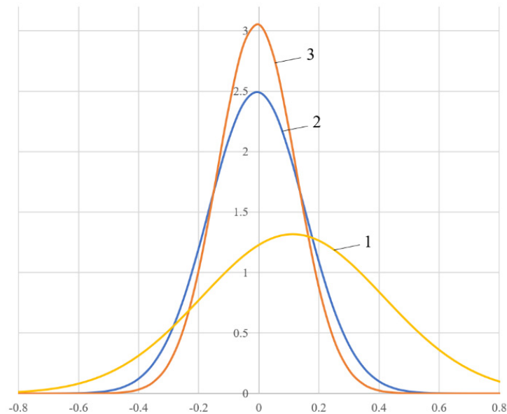
Рис. 3. Графіки функцій щільності ймовірностей помилки передбачення (1 – модель Фатемі-Сосі; 2 – модель нейронної мережі з 30 параметрами; 3 – модель нейронної мережі з 10 параметрами)
