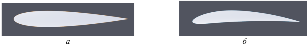
Рис. 2. Модель профілів крила: а) NACA 0012 AIRFOILS (n0012-il), б) NACA 6412 (naca6412-il)
