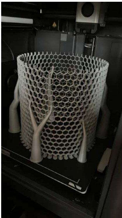
Рис. 5. Виконання стільникових нежорстких систем із проміжними опорами-дендритами
