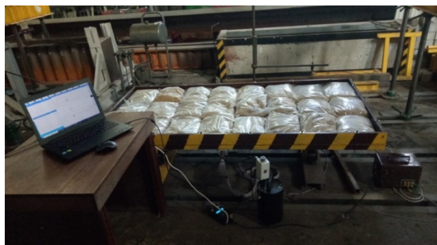
Рис. 1. Експериментальна установка з просторовими коливаннями під час вимірювань динамічних параметрів
