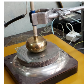
Рис. 4. Обробка сталі 25ХГНМТ ІБР, де: а) схема електродної системи для обробки ІБР зразків сталі 25ХГНМТ, де 1 - досліджуваний зразок 1 сталі 25ХГНМТ, 2 – високовольтний електрод, 3 - діелектричний бар’єр, \delta - газовий проміжок, ВН – висока напруга; б) зовнішній вигляд ІБР; в) зовнішній вигляд процесу обробки ІБР сталі 25ХГНМТ
